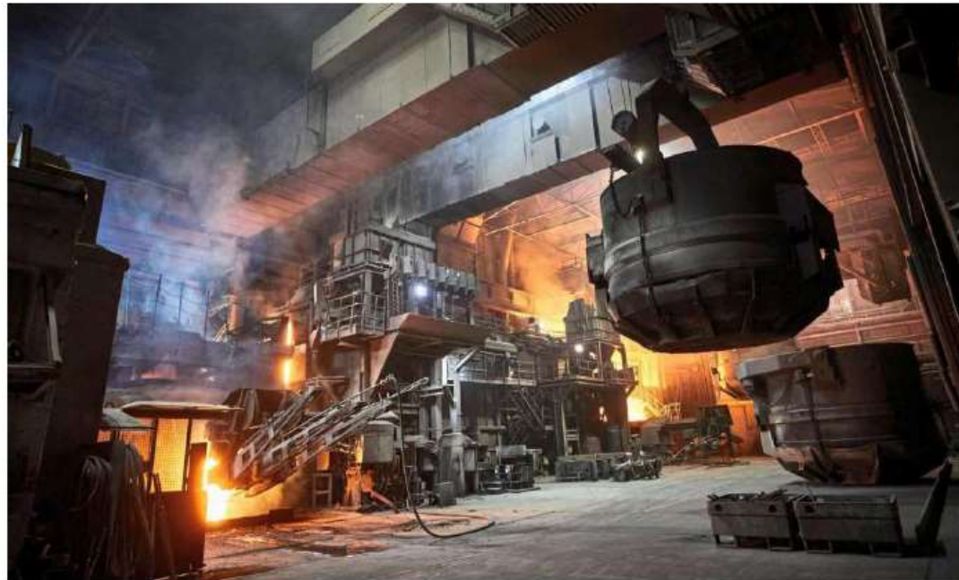
Riesiger Stromverbrauch: Die Badische Stahlwerke GmbH in Kehl gehört zu Deutschlands größten Stahlproduzenten. Sie bringt in ihren zwei Öfen Schrott mit Hilfe von Strom zum Schmelzen. Foto: BSW
