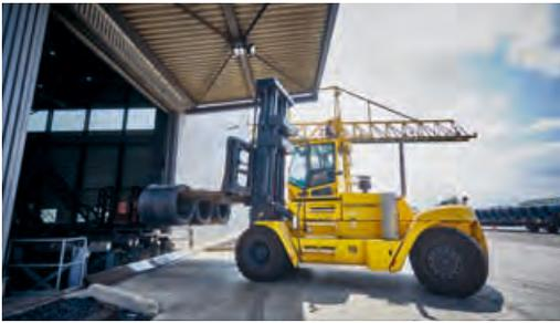
**Oben:** Aus dem Knüppel ist ein Knäuel geworden: Die Coils, wie die Drahtrollen richtig heißen, bringen es je nach Durchmesser des Drahts auf einige Kilometer Länge und auf rund 1,8 Tonnen Gewicht
