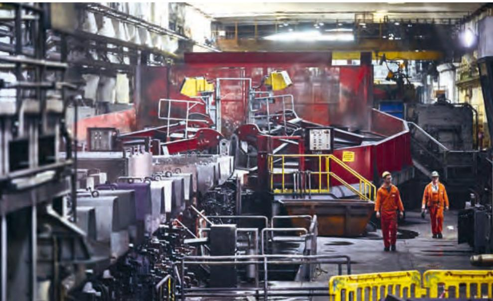
**Oben:** Im Drahtwalzwerk sorgen Walzgerüste dafür, dass aus dicken Knüppeln ein dünner Draht wird. Gesteuert wird die Anlage von Männern wie Felix Tausch (rechts)
