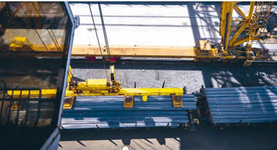
Mithilfe von **Traversen** und Elektromagneten werden die Stahlprodukte an ihren Lagerplatz verbracht. Bis zu zehn Tonnen lupfen die Kräne in einem Arbeitsgang
